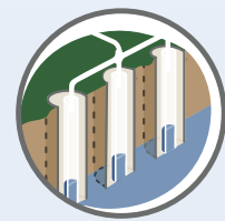
BATERIA DE POÇOS
